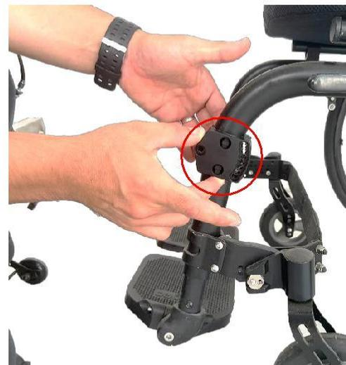
5. Den konischen Stift nur im ersten Loch (Fig. 5a) so montieren, dass die Spitze auf der in der vorherigen Tabelle angegebenen Höhe H liegt; Die Höhentoleranz H korrigieren, indem der konische Stift mit dem Tiefenregler (Abb. 5b) perfekt abgestimmt wird.
