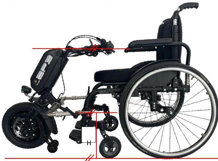
2. Stellen Sie die Parkbremse des Rollstuhls ein und setzen Sie den Hebel vor den Rollstuhl, wobei sich das Rad in der Mitte des Rollstuhls befindet.
