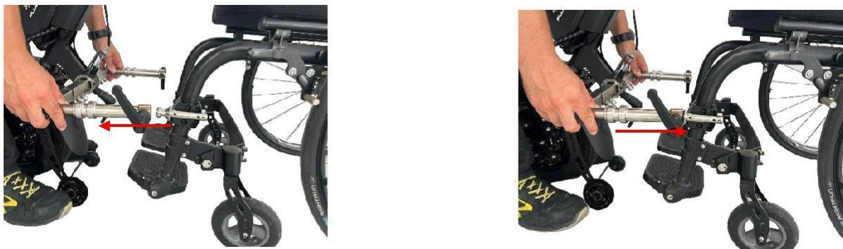
9. Die dritte Schraube in Übereinstimmung mit dem Loch gegenüber der zweiten Schraube (Abb. 9a) anbringen, und die mitgelieferte Flanschmutter (Abb. 9b) ansetzen. Wenn die zweite Schraube in das mittlere Loch gesteckt wird, führen Sie die dritte Schraube in das letzte untere Loch ein (Abb. 9c).
