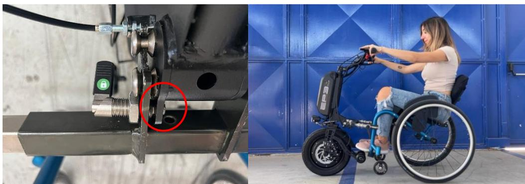
**Hinweis:** Schieben Sie den Lenker leicht nach vorne, damit der Federkolben ungehindert in das Loch eindringen kann.
