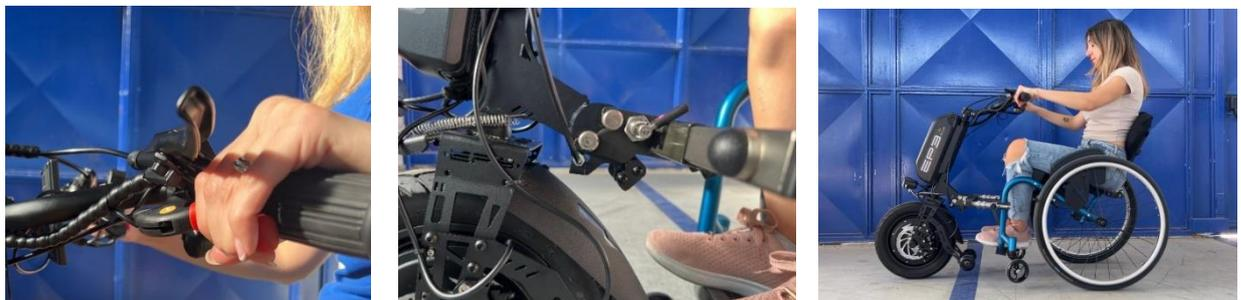
Drehen Sie den Sicherungshebel nach unten und achten Sie darauf, dass der Federstößel wie abgebildet durch das Loch geht.
