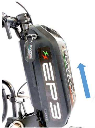
Drehen Sie den Schlüssel gegen den Uhrzeigersinn Entfernen Sie die Batterie, indem Sie sie nach oben schieben
