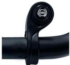
Durch Drücken der RBS-Taste wird diese Funktion aktiviert, wodurch das Triebwerk langsamer werden kann. Abstieg und laden Sie gleichzeitig den Akku auf.
