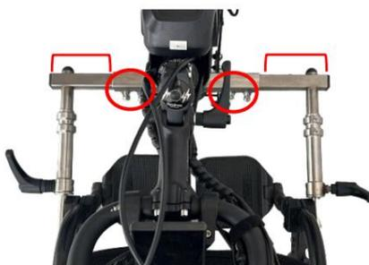
12. Desaparafuse as alavancas de aperto laterais e verifique se ambos os pinos cônicos entram e saem livremente dos respectivos reguladores de profundidade, afastando e aproximando o propulsor (Fig. 12a-12b). **Em seguida, aperte os parafusos de fixação com peso (5-12 Nm), tomando cuidado para não danificar a tubulação da cadeira de rodas.** Por fim, insira as tampas das porcas fornecidas (Fig. 12c)
