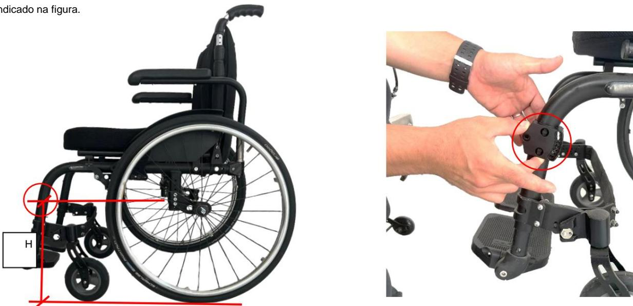
5. Monte o Pino Cônico somente no primeiro furo (Fig. 5a) de forma que a ponta fique na altura H indicada na tabela anterior; corrija a tolerância de altura H combinando perfeitamente o pino cônico com o ajustador de profundidade (Fig 5b).
