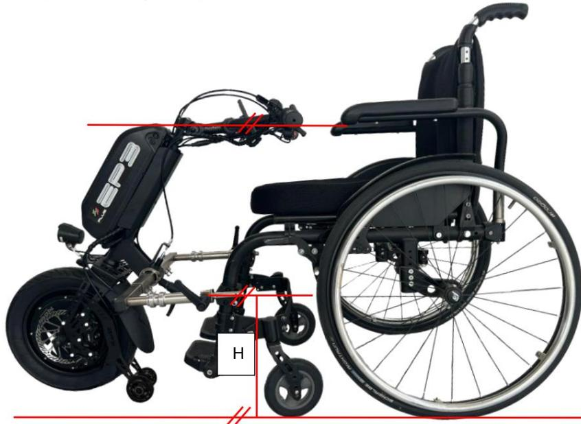
2. Acione os freios de estacionamento da cadeira de rodas e posicione o propulsor na frente da cadeira de rodas com o roda no centro da cadeira de rodas
