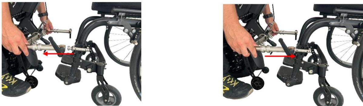
9. Adicione o terceiro parafuso no orifício oposto àquele onde o segundo parafuso foi inserido (Fig. 9a), acrescentando a porca flangeada fornecida (Fig. 9b). Se o segundo parafuso for inserido no furo central, insira o terceiro parafuso no último furo inferior (Fig. 9c).
