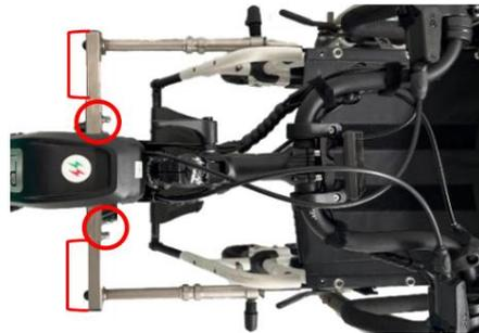
13. Desparafuse as alavancas de aperto laterais e verifique se ambos os pinos cônicos entram e saem livremente dos respectivos reguladores de profundidade, afastando e aproximando o propulsor (Fig. 13a-13c). **Em seguida, aperte os parafusos de fixação com peso (5-12 Nm), tomando cuidado para não danificar a tubulação da cadeira de rodas.** Por fim, insira as tampas das porcas fornecidas (Fig. 13c)
