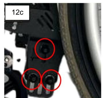
14. Se necessário, atue nas buchas do regulador de profundidade para ajustar a distância do guidão pelo usuário, aproximando ou afastando o regulador ao longo do braço e apertando com um torque de 12 Nm.
