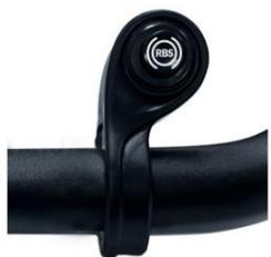
Un appui sur le bouton RBS activera cette fonction qui permet au propulseur de ralentir descente et charger la batterie en même temps.
