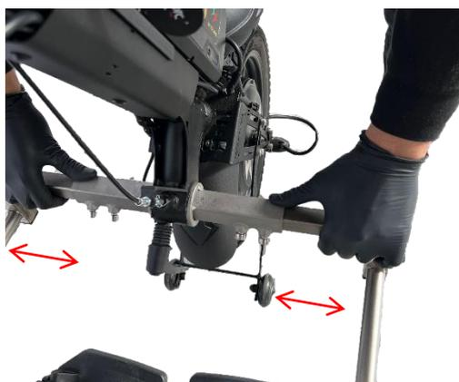
Verificare che entrambe Le Spine Coniche entrino ed escano liberamente dai rispettivi regolatori di profondità allontanando e avvicinando il propulsore (fig. 22,23). Quindi serrare le leve di serraggio laterali (fig. 24).
