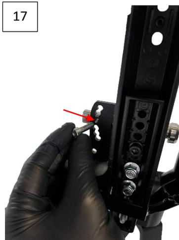
7. Serrare tutte le viti M6 con chiave dinamometrica con coppia di serraggio di 12 Nm
