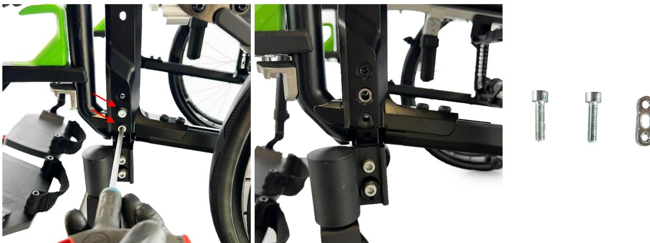
2. Inserire dal lato esterno nel foro centrale la vite M6x30 (fig. 4). Inserire n. 2 rondelle sull'estremo opposto lato interno (fig. 5), quindi avvitare leggermente il dado M6 flangiato (fig. 6).
