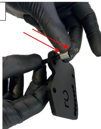
5. Inserire nel foro inferiore della forcella la vite appena inserita sulla piastra (fig. 12), serrare la vite centrale M6x30, quindi posizionare la piastra inserendo la parte filettata della vite superiore nel foro centrale della piastra (fig. 13). Avvitare leggermente il dado della vite inferiore (fig. 14).
