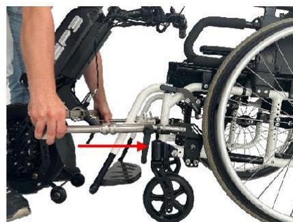
14. Si nécessaire, agir sur les chevilles du régulateur de profondeur pour régler la distance entre le guidon et l'utilisateur, en rapprochant ou en éloignant le régulateur le long du bras, puis serrer avec un couple de serrage de 12Nm.
