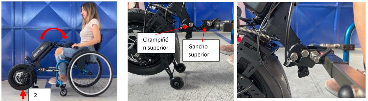
Accione la palanca de desbloqueo y empuje firmemente el manillar hacia delante hasta que el gancho inferior intercepte la seta inferior, luego suelte la palanca de desbloqueo.
