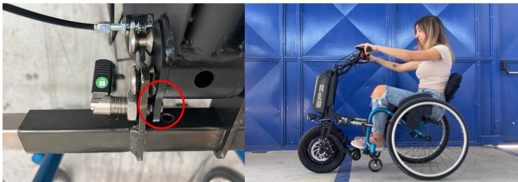
**Nota:** empuje ligeramente el manillar hacia delante para que el émbolo del muelle pueda entrar libremente en el orificio.
