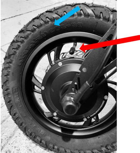
La flecha azul indica las características del neumático, la flecha roja indica la válvula de inflado. La presión correcta varía en función del neumático.
