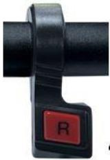
Quando viene inserita la retromarcia (premendo il pulsante una volta), il display indicherà la scritta REVERSE lampeggiante in arancione.
