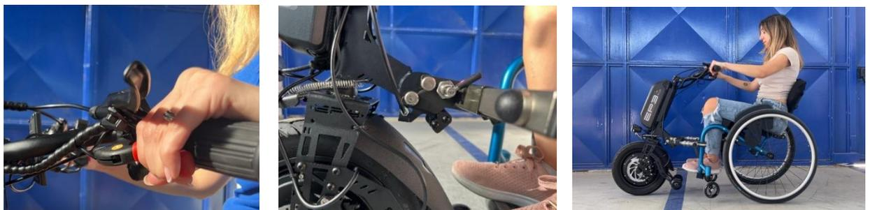
Gire la palanca de seguridad hacia abajo y asegúrese de que el émbolo del muelle atraviesa el orificio tal y como se muestra.
