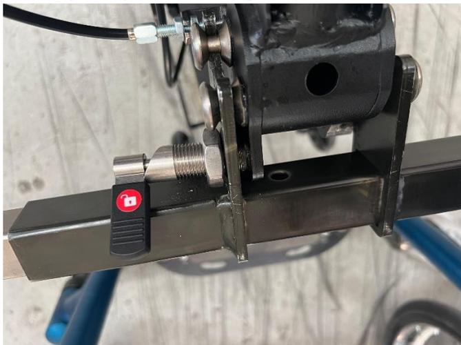
Baje ligeramente el manillar levantando la rueda unos 2 cm del suelo como se muestra en la ilustración, mueva el propulsor libremente hacia el mecanismo de conexión sin interferencias. (la seta superior del propulsor debe encajar dentro del gancho superior del arco)
