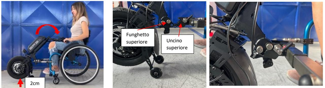
Azionare la leva di sblocco e spingere in maniera decisa il manubrio in avanti sino a che l'uncino inferiore intercetti il funghetto inferiore, quindi rilasciare la leva di sblocco.
