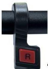
Quando viene inserita la retromarcia (premendo il pulsante una volta), il display indicherà la scritta REVERSE lampeggiante in arancione.
