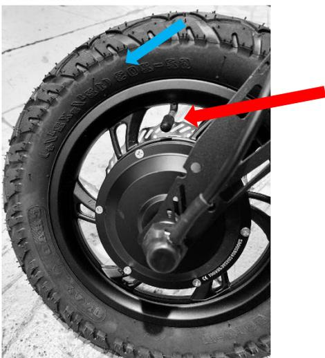
La **freccia blu** indica le caratteristiche della gomma, quella **rossa** indica la valvola di gonfiaggio. La pressione corretta di utilizzo varia in funzione della gomma.
