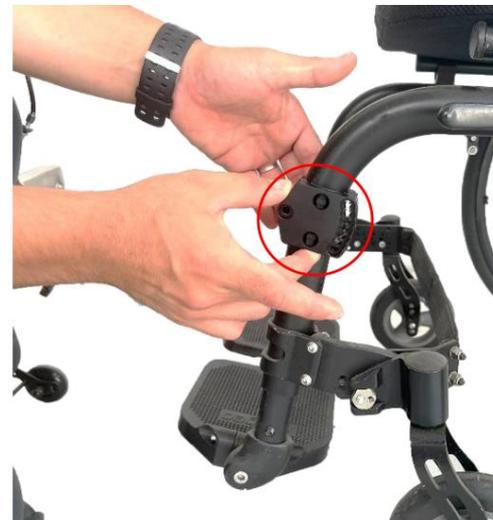
5. Montar el Pasador Cónico únicamente en el primer orificio (Fig. 5a) de modo que la punta quede a la altura H indicada en la tabla anterior; corrija la tolerancia de altura H haciendo coincidir perfectamente el pasador cónico con el ajustador de profundidad (Fig. 5b).
