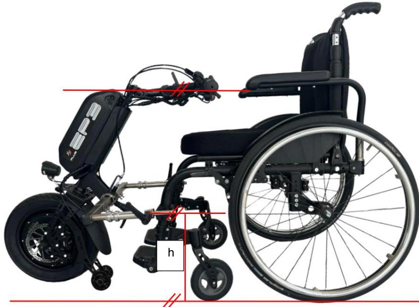
2. Aplique los frenos de estacionamiento de la silla de ruedas y coloque el propulsor delante de la silla de ruedas con el rueda en el centro de la silla de ruedas
