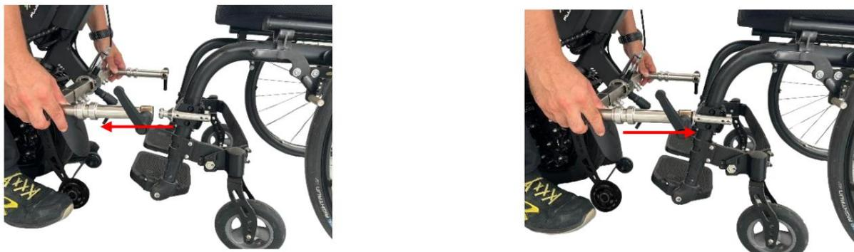
9. Agregue el tercer tornillo en el orificio opuesto a aquel donde se insertó el segundo tornillo. (Fig. 9a), añadiendo la tuerca bridada suministrada (Fig. 9b). Si el segundo tornillo se inserta en el orificio central, inserte el tercer tornillo en el último orificio inferior (Fig. 9c).
