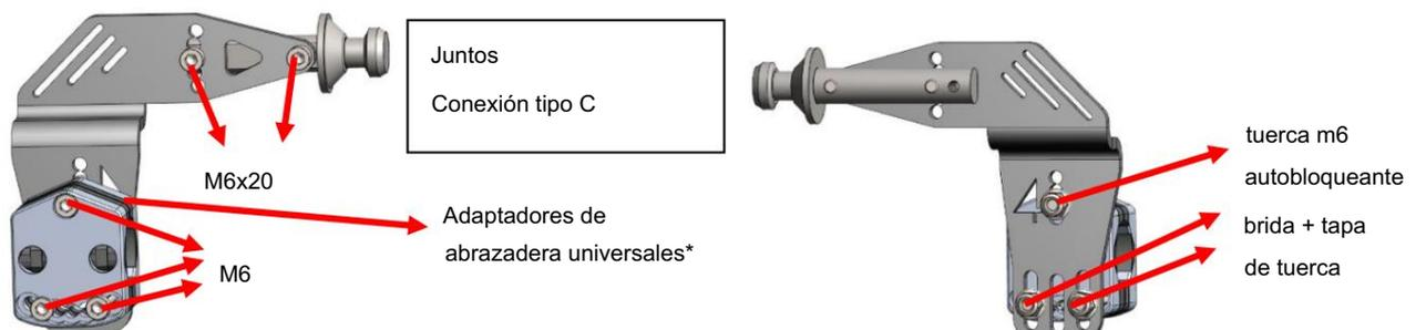
\*Se pueden utilizar adaptadores de abrazadera universales excepto si hay tuercas o tornillos en el marco de la silla de ruedas que podrían causar interferencias
