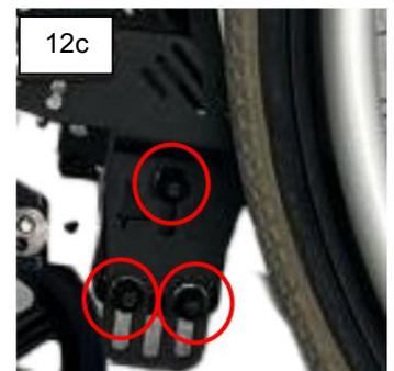
14. Si es necesario, actuar sobre los tacos del regulador de profundidad para ajustar la distancia del manillar. por el usuario, acercando o alejando el regulador a lo largo del brazo, luego apretar con un par de apriete de 12 Nm.
