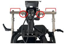
12. Svitare le leve di serraggio laterali e verificare che entrambe Le Spine Coniche entrino ed escano liberamente dai rispettivi regolatori di profondità allontanando e avvicinando il propulsore (Fig. 12a-12b).
