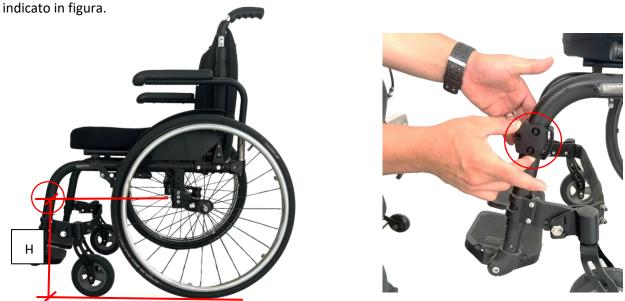
5. Montare la Spina Conica solo nel primo foro (Fig. 5a) in modo che la punta sia all'altezza H indicata in tabella precedente; correggere la tolleranza dell'altezza H facendo combaciare perfettamente la Spina Conica con il Regolatore di Profondità (Fig 5b).
