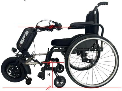
2. Inserire i freni di stazionamento della carrozzina e posizionare il propulsore davanti la carrozzina con la ruota al centro della carrozzina
