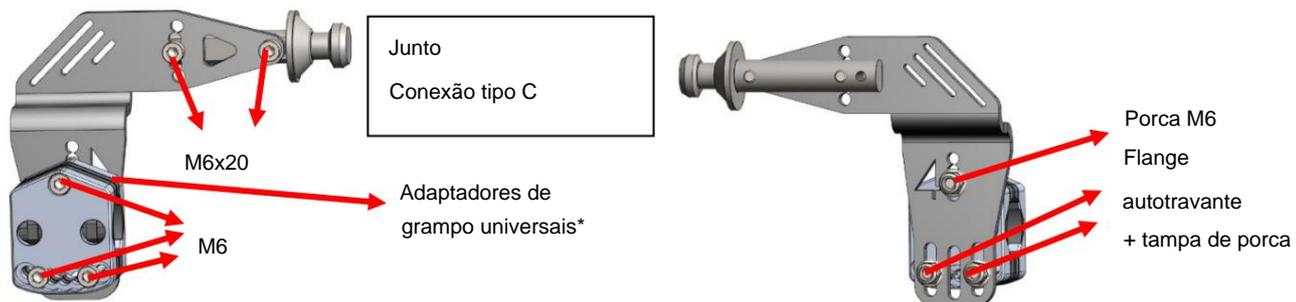
\*Adaptadores de grampo universais sempre podem ser usados, exceto se houver porcas ou parafusos na estrutura da cadeira de rodas que pode causar interferência
