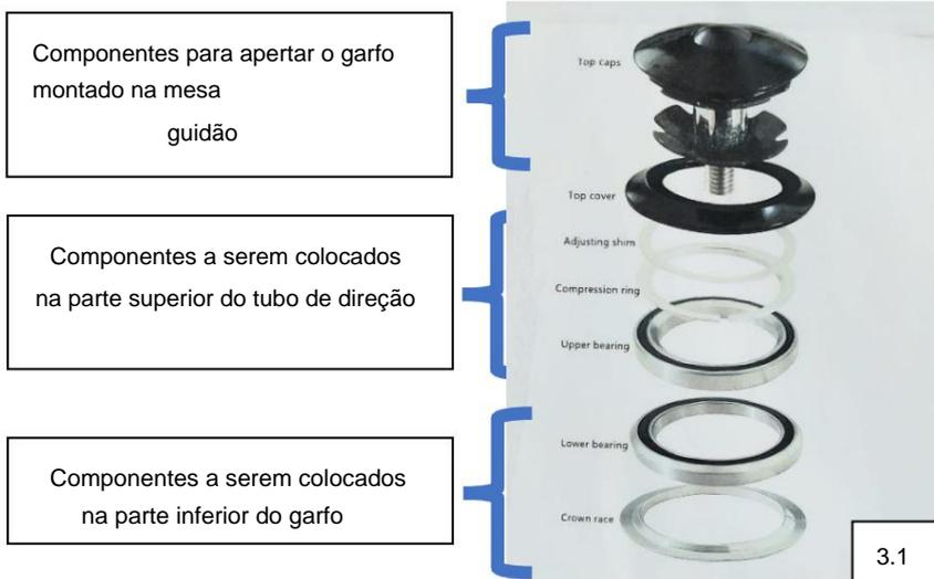
1. Disponha os componentes que serão posicionados na parte inferior, até que eles toquem a placa inferior (Fig 4), em seguida insira a haste do garfo no tubo de direção até atingir o batente (Fig 5).
