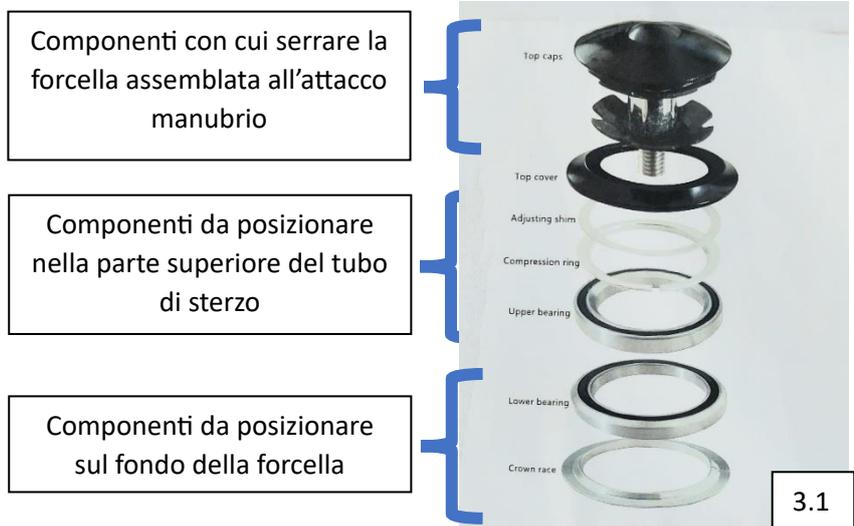
1. Disporre i componenti che vanno posizionati sul fondo, fino ad arrivare a battuta con la piastra inferiore (Fig 4), poi infilare lo stelo della forcella nel tubo di sterzo, fino ad arrivare a battuta (Fig 5).
