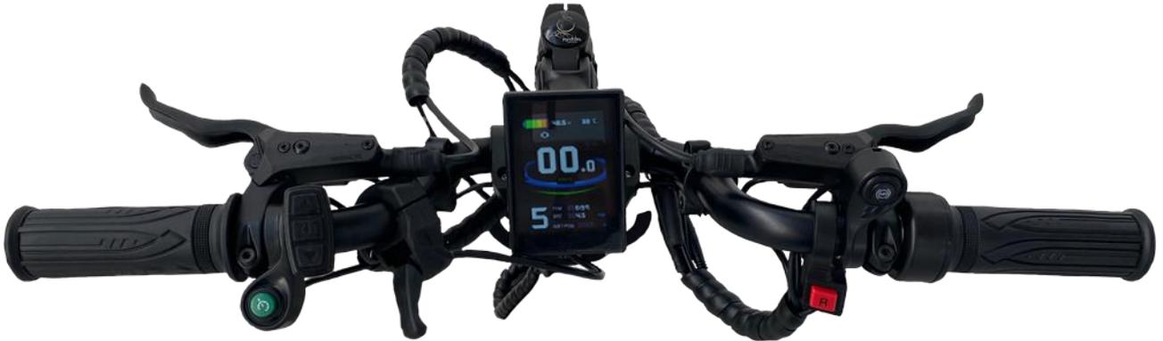
Pulsanti e leve possono essere regolati e disposti nel modo più comodo per l'utente. Alcuni comandi possono essere spostati da destra a sinistra e viceversa. Il fissaggio dei morsetti avviene tramite una vite a croce oppure una esagonale.
