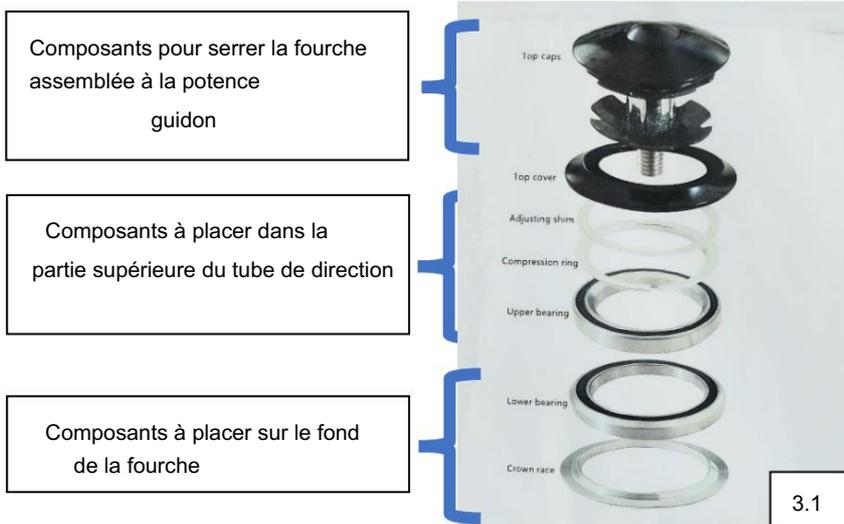
1. Disposez les composants qui doivent être positionnés sur le fond, jusqu'à ce qu'ils touchent la plaque abaisser (Fig 4), puis insérez la potence de la fourche dans le tube de direction jusqu'à atteindre la butée (Fig 5).
