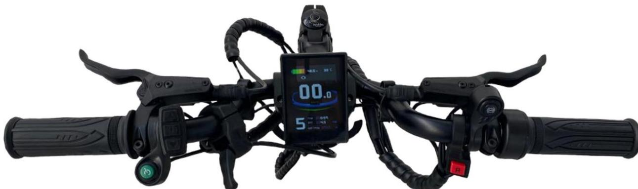
Les boutons et les leviers peuvent être réglés et disposés de la manière la plus confortable pour l'utilisateur. Certaines commandes peuvent être déplacées de droite à gauche et vice versa. Les pinces sont fixées à l'aide d'une vis cruciforme ou hexagonale.
